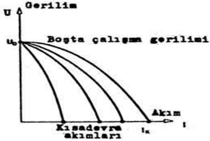
Şekil 1. Düşey karakteristikli bir makinanın statik karakteristikleri.
