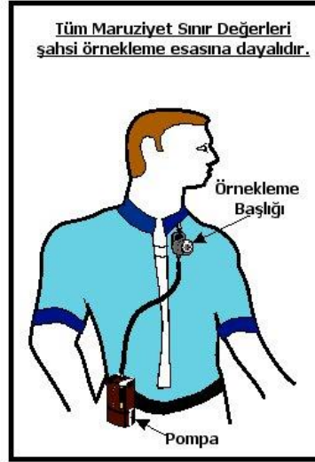
Şekil 4. Toz numunesi alma düzeneği ve işçi üzerine yerleştirilme şekli [1].
