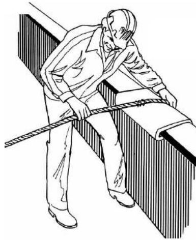
Şekil:16 prüzlü veya kesici yüzeyin kauçuk bant veya halı parçasıyla desteklenmesi
