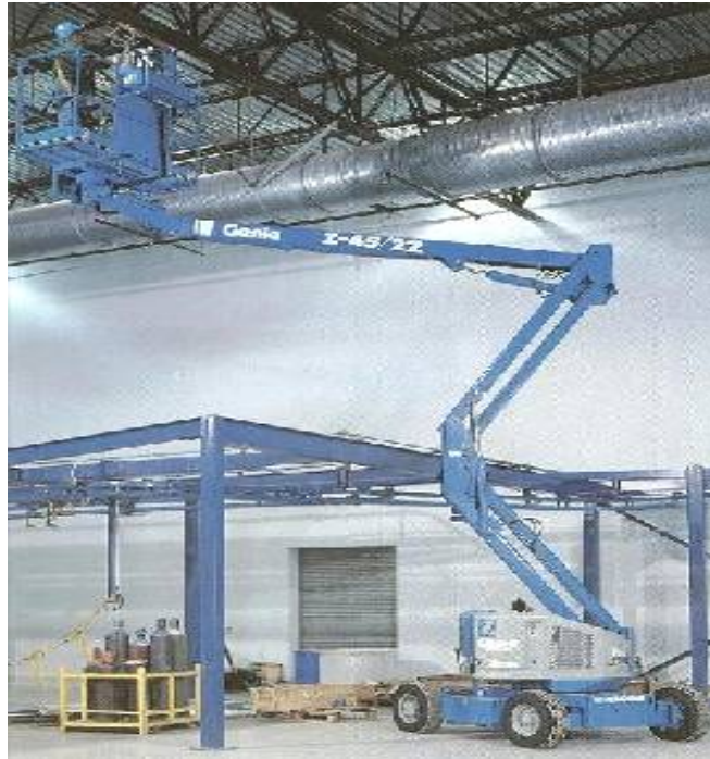
Resim 4.Hidrolik platformlar kapasitelerinden fazla yüklenmemeli
