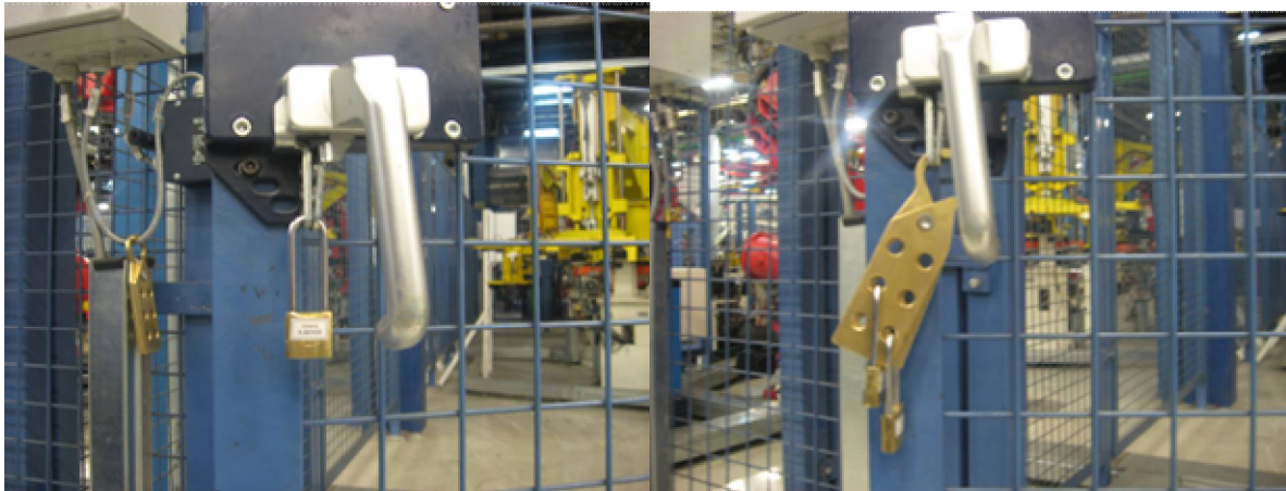
Resim 3: Robotik üretim hücresine girişte kilitleme uygulaması: tekli ve çoklu reset önleyici kilitler
