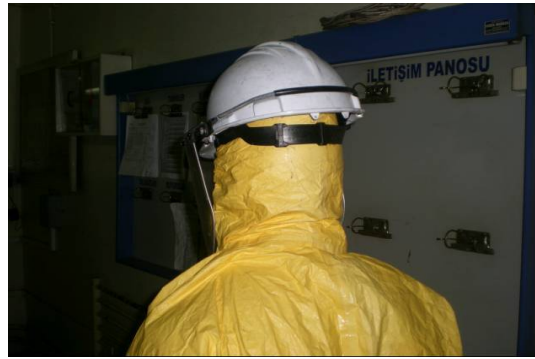
Fotoğraf-9 Sülfürik asitle çalışırken kullanılan barete ilave takılan koruyucu siperlik uygulaması
