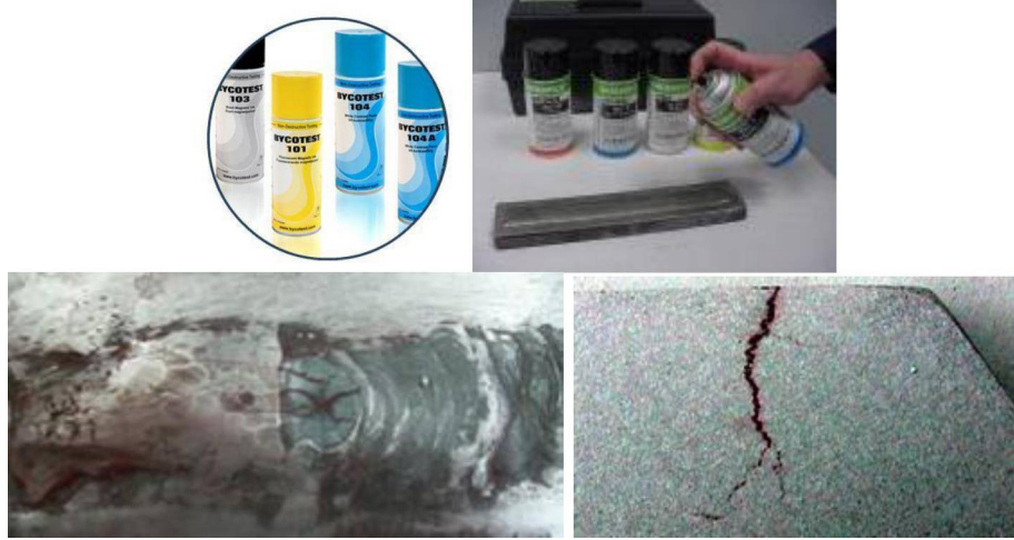
Sekil. Penetrant Sıvıları ve Muayene Uygulamaları
