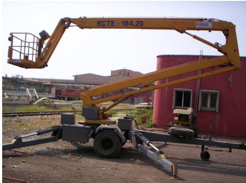
Resim 6.İSDEMİR’de kullanılan ayakları tam açılmış hidrolik ekleml platform.
