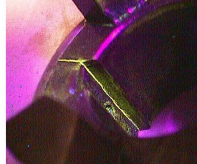
Sekil. Manyetik Parçacıkla Cıvata Muayenesi
