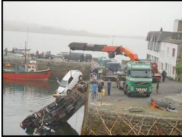
Resim.5 Kaldırılan Yükün Ağırlığının Doğru Tespit Edilmemesi Neticesinde Yaşanan Kaza
