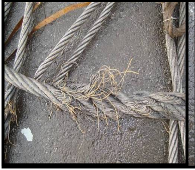
Resim.7 Yüke Uygun Sapan Seçilmemesi Neticesinde Yaşanan Olay
