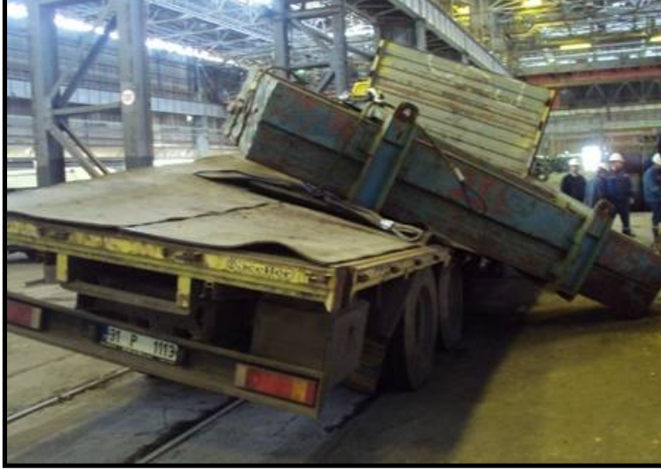
Resim.7 Yüke Uygun Sapan Seçilmemesi Neticesinde Yaşanan Olay
