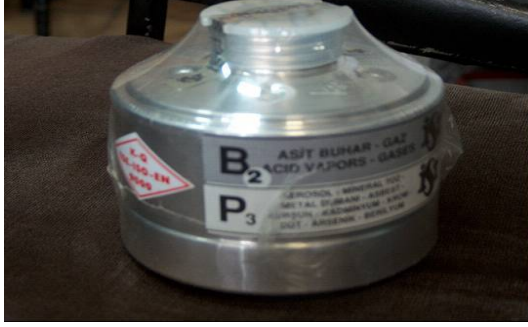
Fotoğraf-11 Sülfürik asitle çalışırken ihtiyaç duyulduğunda kullanılan Asit buharına uygun kartuş ve tam yüz maskesi
