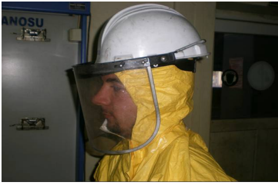
Fotoğraf-9 Sülfürik asitle çalışırken kullanılan barete ilave takılan koruyucu siperlik uygulaması
