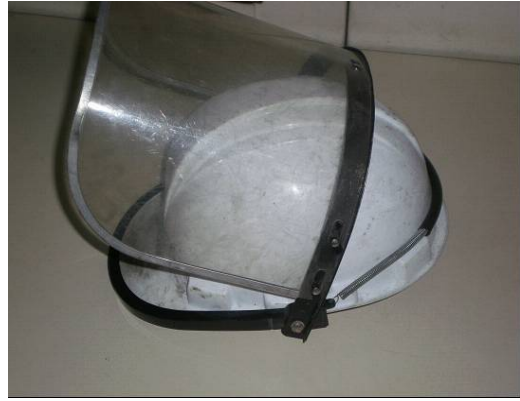
Fotoğraf-8 Sülfürik asitle çalışırken kullanılan ve barete ilave takılan koruyucu siperlik
