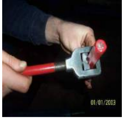
Tutucu kol mengene ye el aleti yerleştirme şekli
