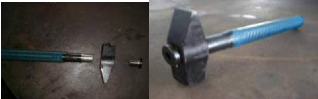
Metal saplı çekiç montajı
